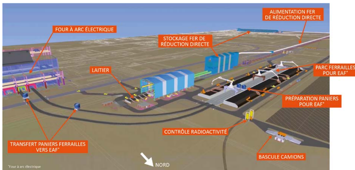
Vue 3D de l'implantation du four à arc électrique sur le site Fos-sur-Mer
